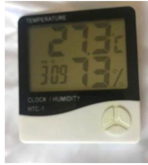
شكل (11.4): جهاز HTC-1 الذي استخدم لقياس درجات حرارة الهواء والرطوبة النسبية
